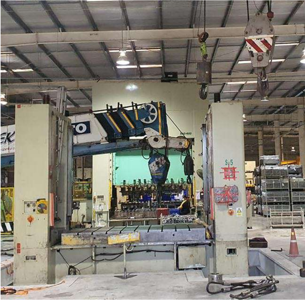
600 Ton Press Model : SAG-600 Bolster : 3100 x 1550 mm
