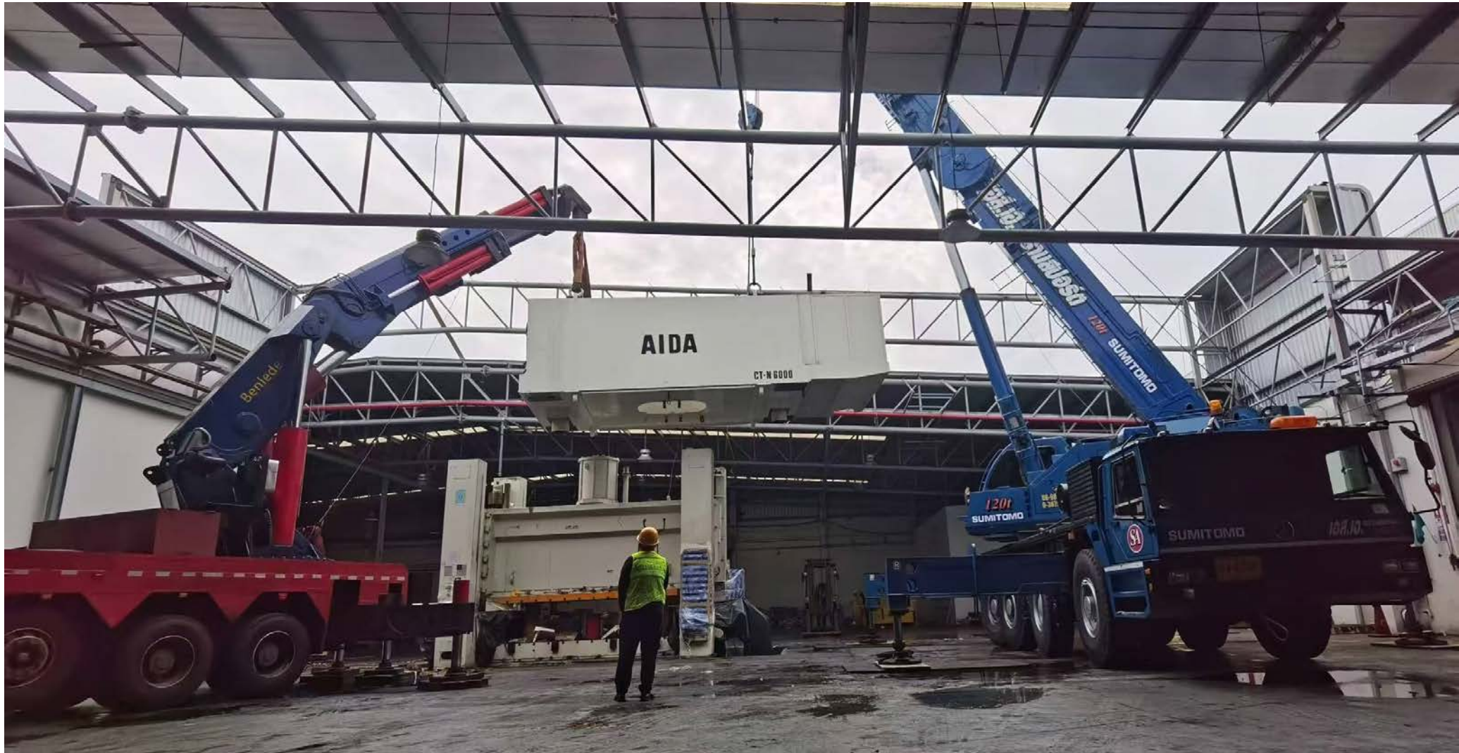
Dis-assembly 600 Ton Aida Press Model : CT-N-6000. Total Weight : 157 Ton
