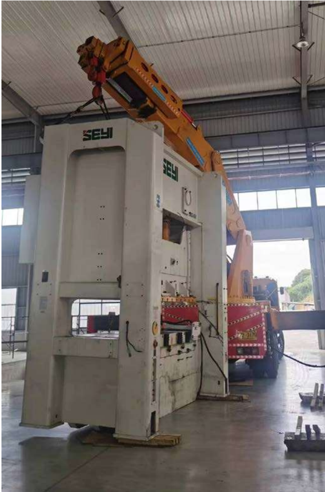
Installation 400 Ton Seyi Press Model : SNS2-400 (Bolster 3400 x 1100 mm). Weight : 54 Ton
