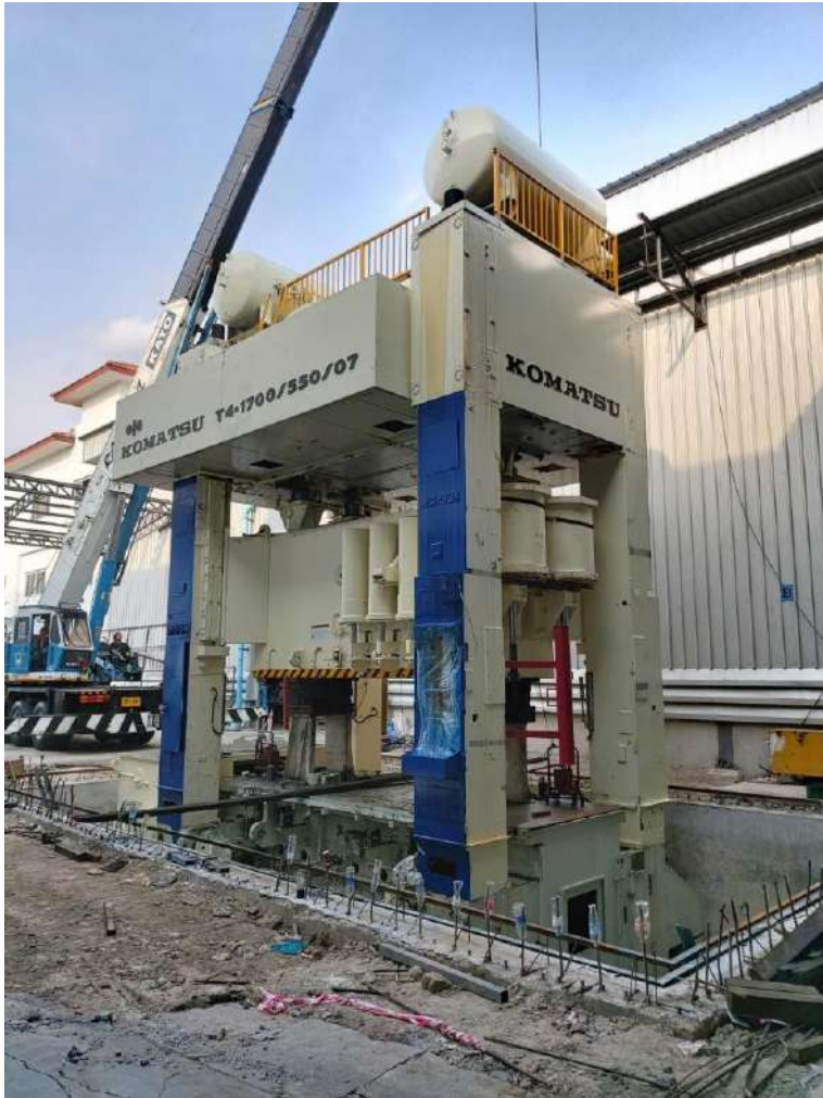
1700 Ton Komatsu Press Total Weight : 565 ton
