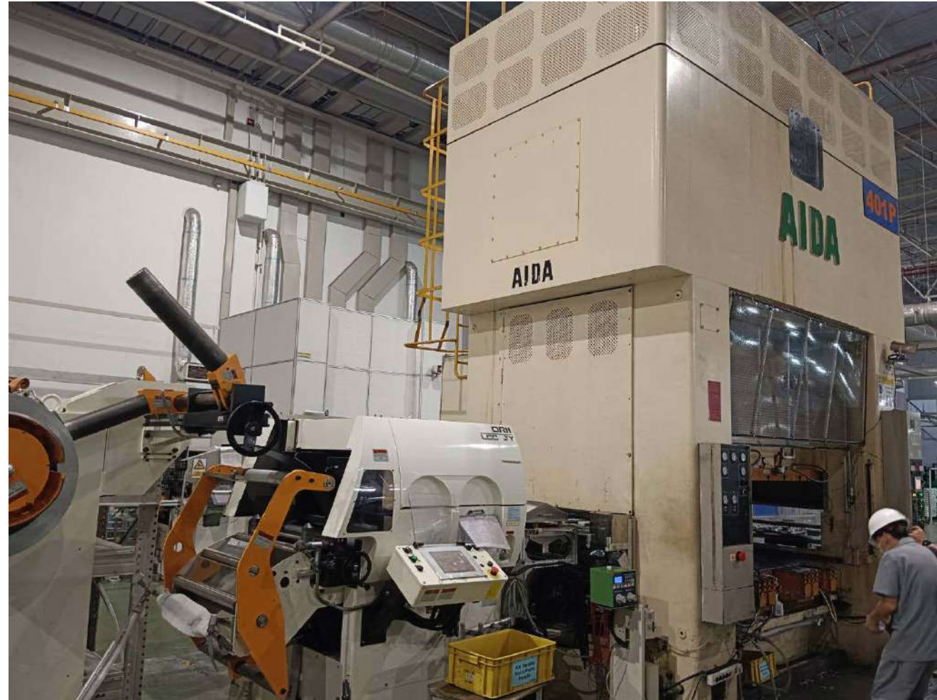
Assembly 400 Ton Aida Press Model : PMX-L2-4000. Total Weight : 84 Ton
