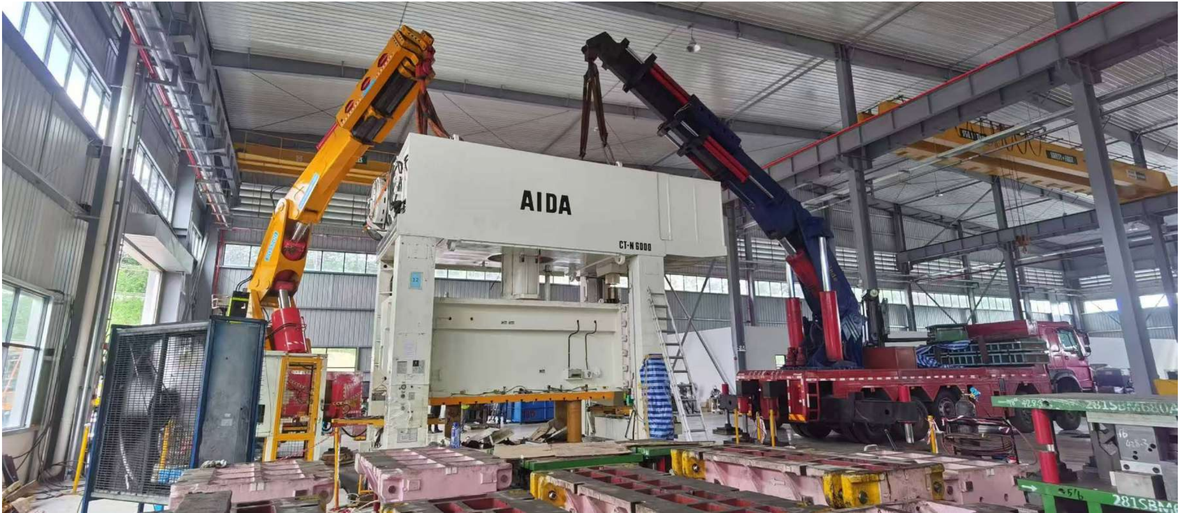
Assembly 600 Ton Aida Press Model : CT-N-6000. Total Weight : 157 Ton
