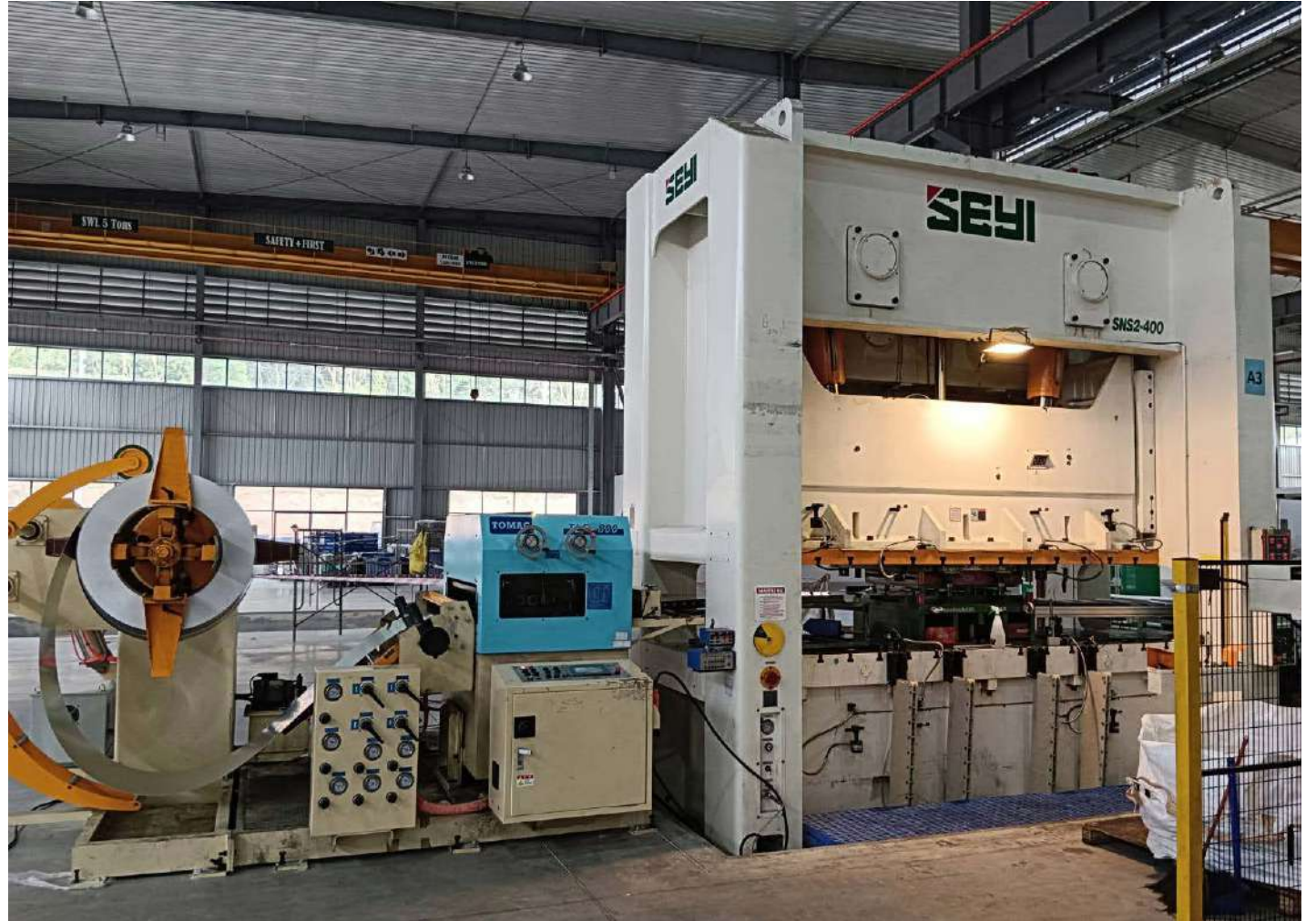
Installation 400 Ton Seyi Press Model : SNS2-400 (Bolster 3400 x 1100 mm). Weight : 54 Ton
