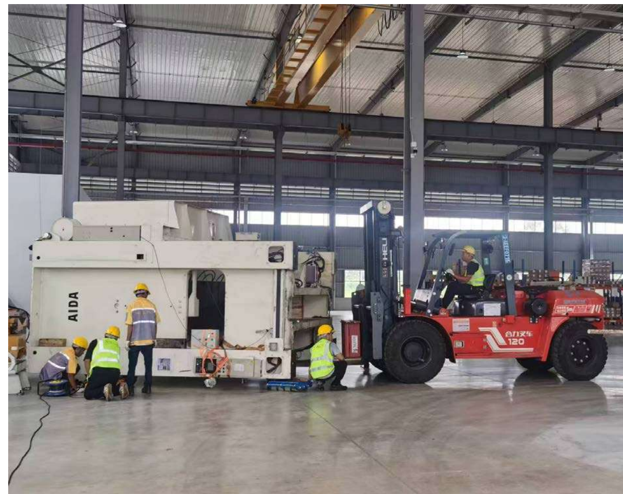
Installation 300 Ton Aida Press Model : NS2-3000. Total Weight : 45 Ton
